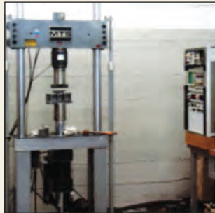
Fatigue resistance testing Misurazione resistenza a fatica
